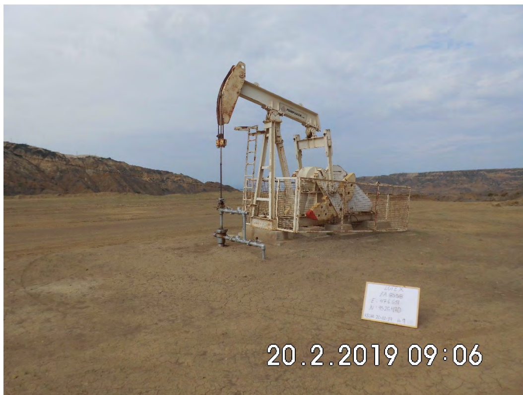
Fotografía 1. Pozo EA8358 (Coordenadas WGS84-zona 17S: 476617mE, 9525470mN), pozo productivo tipo BM. Vista desde cerca del pozo. Sin indicio de derrame de hidrocarburos ni alteración de suelo.
