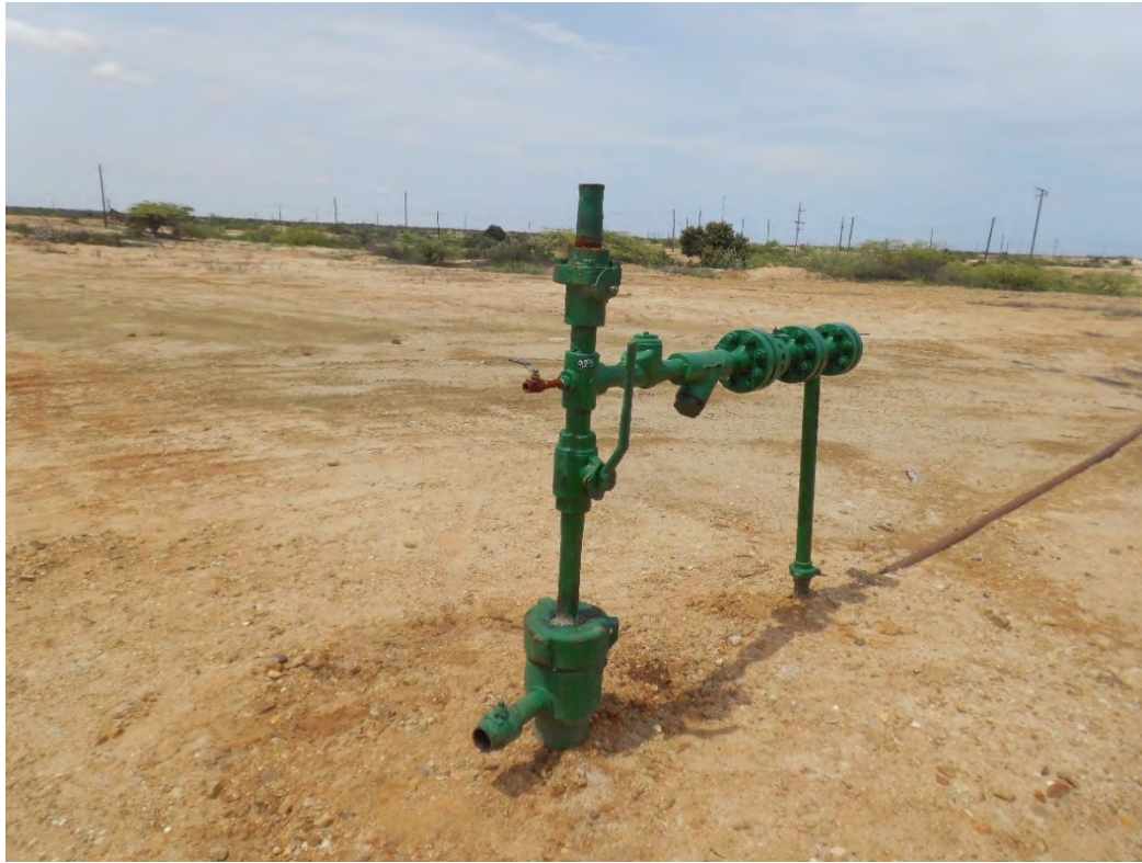
Fotografía 1. Pozo AA9891 (Coordenadas WGS84-zona 17S: 480193mE, 9514351mN), batería inyector tipo ACTINYA. Vista desde cerca del pozo. Sin indicio de derrame de hidrocarburos ni alteración de suelo.
