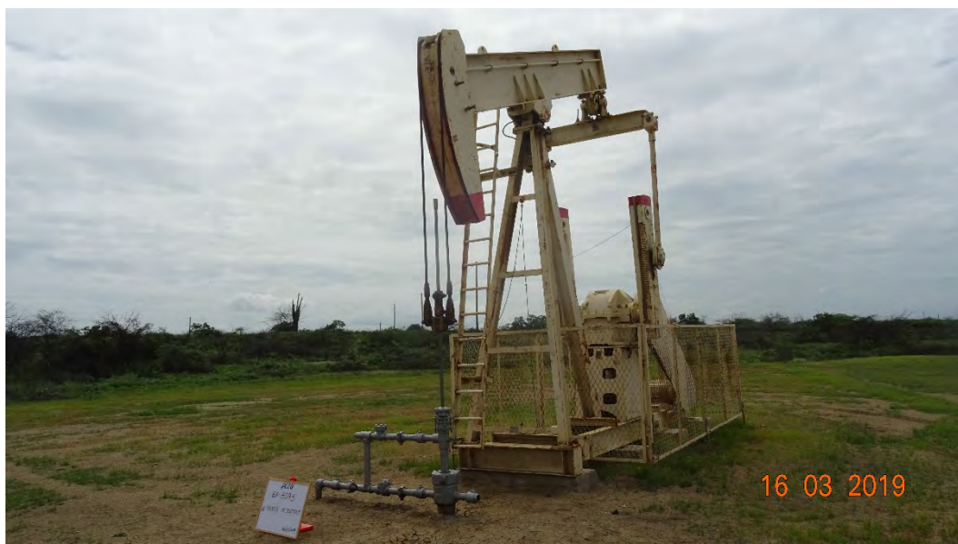
Fotografía 1. Pozo EA8093 (Coordenadas WGS84-zona 17S: 483005mE, 9529425mN), pozo productor tipo BM. Vista desde cerca del pozo. Sin indicio de derrame de hidrocarburos y alteración de suelo.
