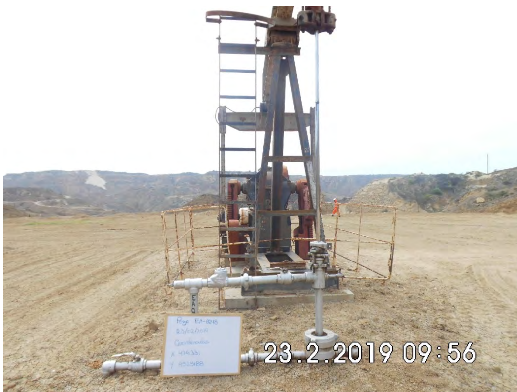
Fotografía 1. Pozo EA8248 (Coordenadas WGS84-zona 17S: 474331mE, 9525188mN), pozo productor tipo BM. Vista de cerca al pozo. Sin indicio de derrame de hidrocarburos ni alteración de suelo.
