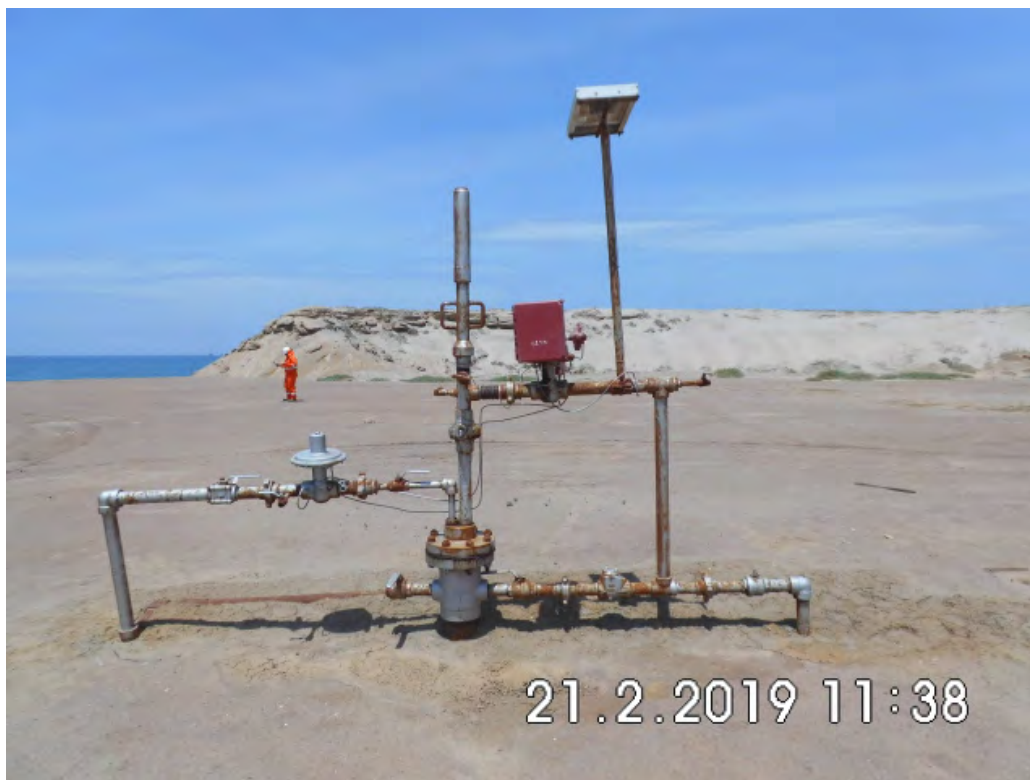
Fotografía 1. Pozo EA8143D (Coordenadas WGS84-zona 17S: 471325mE, 9523540mN), pozo productor tipo plunger lift. Vista desde cerca del pozo. Sin indicio de derrame de hidrocarburos ni alteración de suelo.
