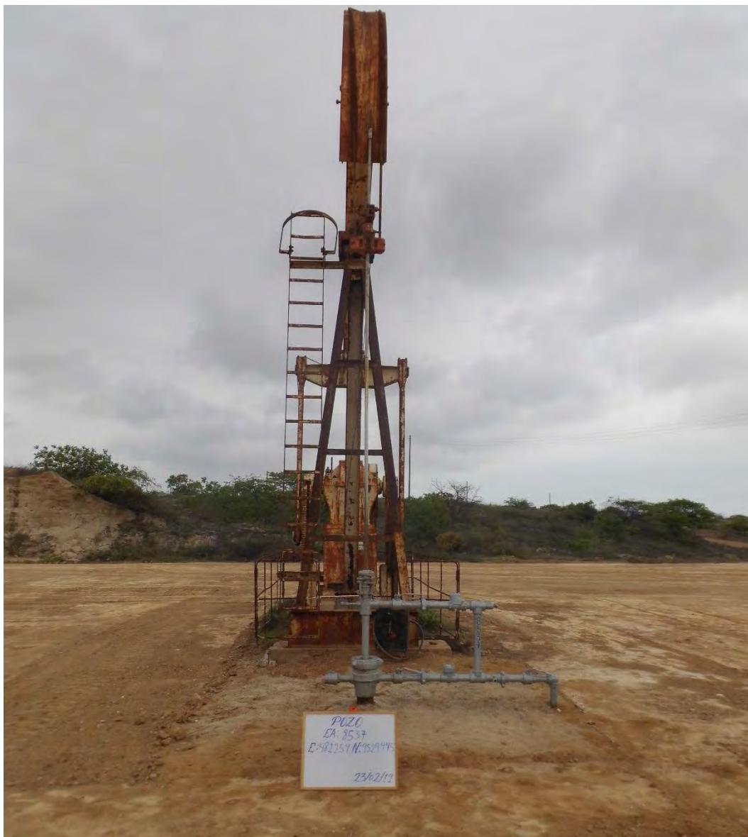
Fotografía 1. Pozo EA8537 (Coordenadas WGS84-zona 17S: 482254mE, 9529178mN), pozo productor tipo BM. Sin indicio de derrame de hidrocarburos ni alteración de suelo.
