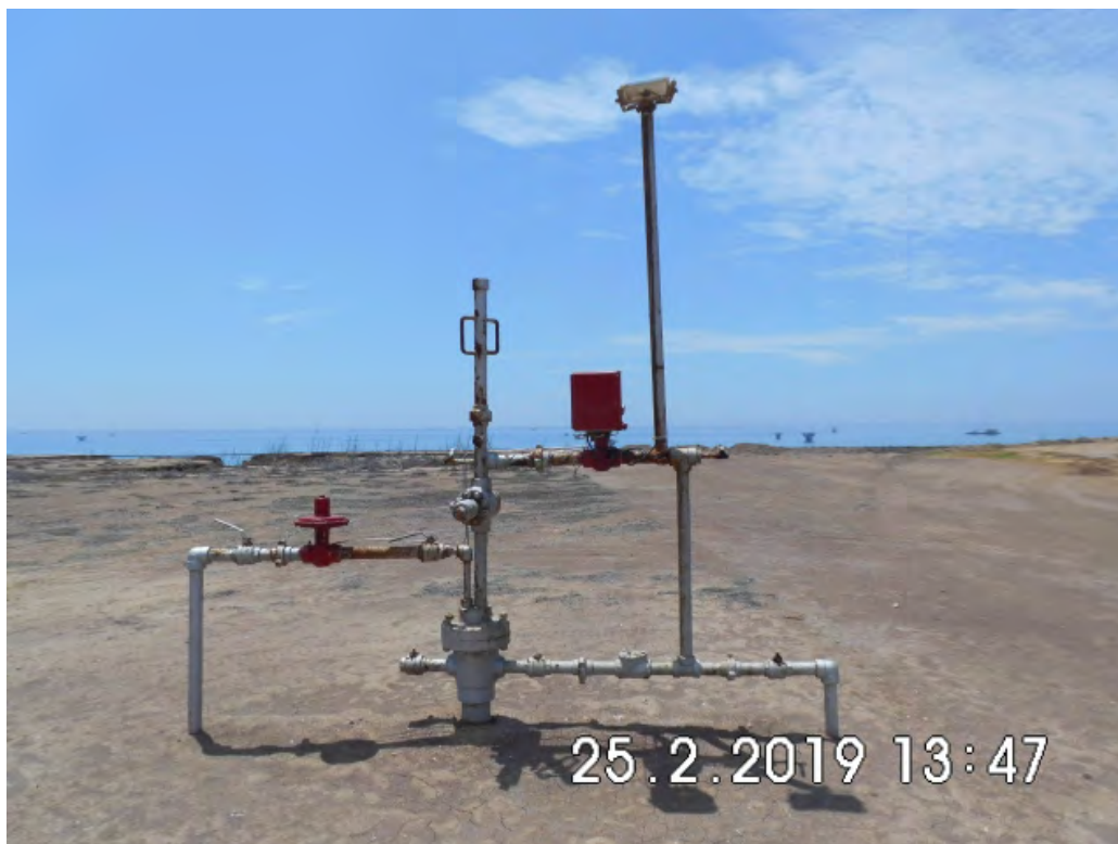
Fotografía 1. Pozo EA8141D (Coordenadas WGS84-zona 17S: 471725mE, 9525091mN), pozo productor tipo PL. Vista de cerca al pozo. Sin indicio de derrame de hidrocarburos ni alteración de suelo.
