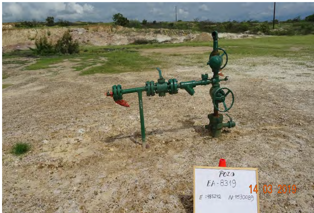
Fotografía 1. Pozo EA8319 (Coordenadas WGS84-zona 17S: 485242mE, 9530089mN), pozo productor tipo INACTINYA. Sin indicio de derrame de hidrocarburos ni alteración de suelo.
