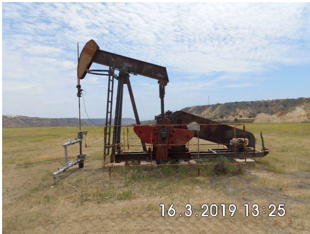
Fotografía 1. Pozo EA8233 (Coordenadas WGS84-zona 17S: 476508mE, 9526704mN), pozo productor tipo BM. Vista de cerca al pozo. Sin indicio de derrame de hidrocarburos ni alteración de suelo.
