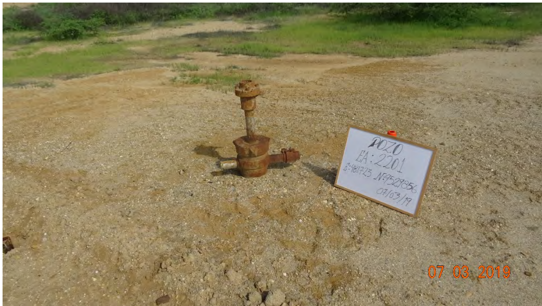
Fotografía 1. Pozo EA2201 (Coordenadas WGS84-zona 17S: 481723mE, 9529856mN), batería inyector inactivo tipo INACTINYA. Vista desde cerca del pozo. Sin indicio de derrame de hidrocarburos ni alteración de suelo.
