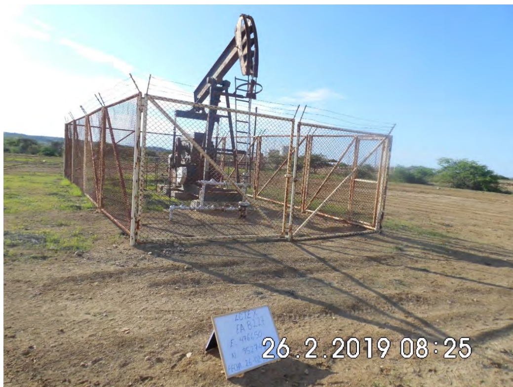
Fotografía 1. Pozo EA8227 (Coordenadas WGS84-zona 17S: 476650mE, 9527498mN), pozo productor tipo BM. Vista de cerca al pozo. Sin indicio de derrame de hidrocarburos ni alteración de suelo.
