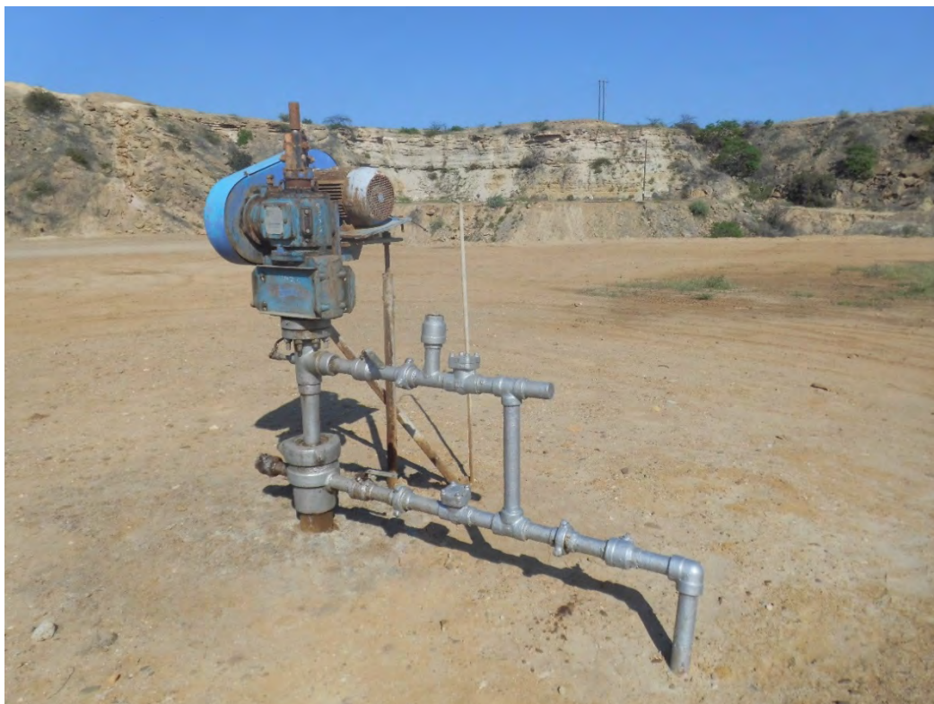
Fotografía 1. Pozo EA8276 (Coordenadas WGS84-zona 17S: 478887mE, 9514187mN), pozo productor tipo bomba de cavidad progresiva en buen estado. Vista desde cerca del pozo. Sin indicio de derrame de hidrocarburos ni alteración de suelo.
