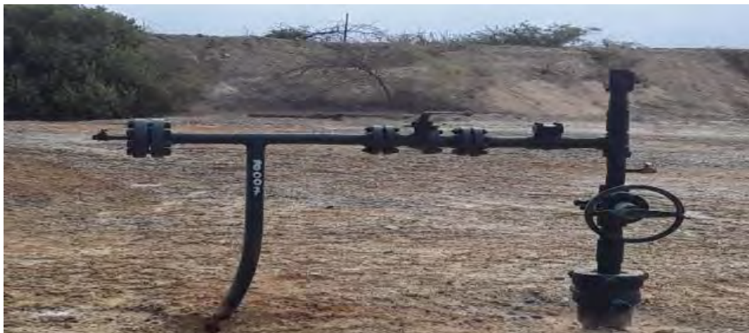
Fotografía 1. Pozo EA8007 (Coordenadas WGS84-zona 17S: 487799mE, 9531074mN), pozo inyector tipo ACTINYA. Vista desde cerca del pozo.
