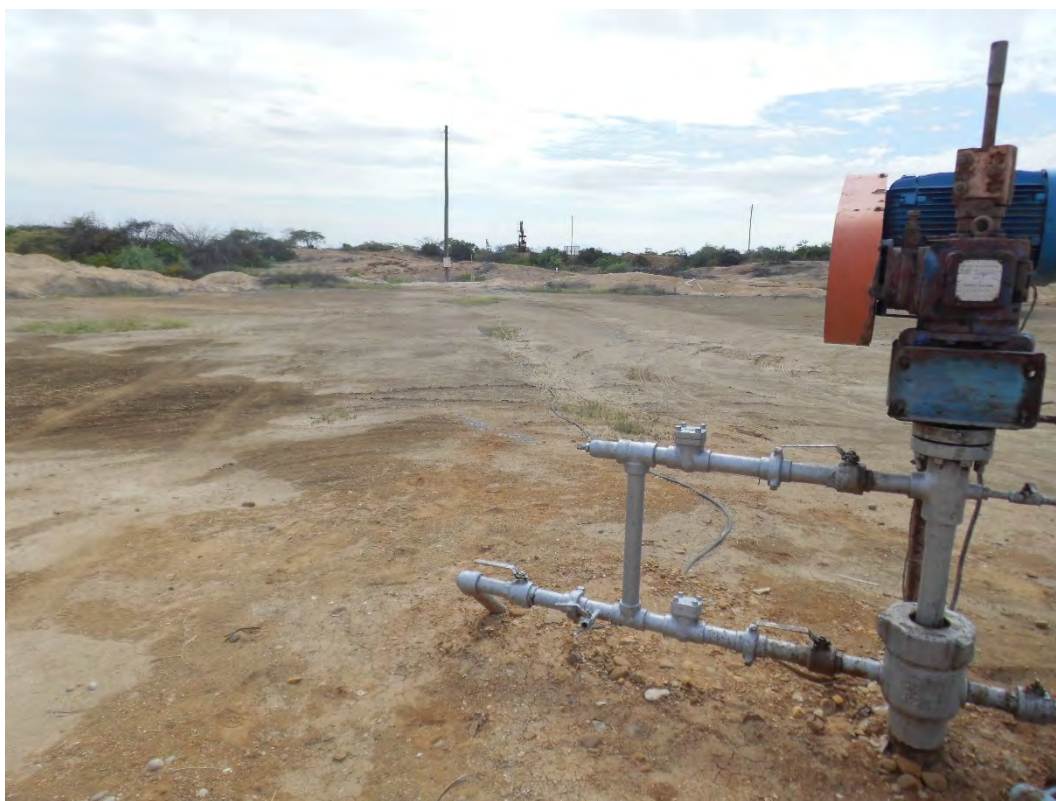
Fotografía 1. Pozo AA8127 (Coordenadas WGS84-zona 17S: 478511mE, 9513985mN), pozo productor tipo BCP. Vista desde cerca del pozo.
