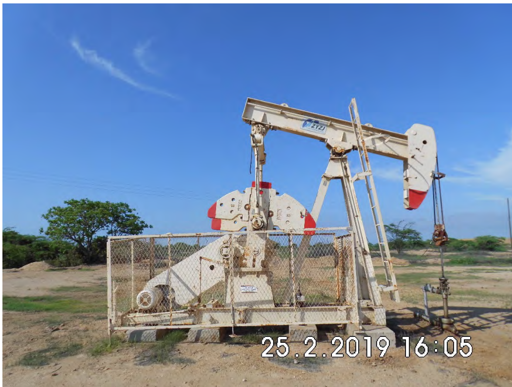
Fotografía 1. Pozo AA8059 (Coordenadas WGS84-zona 17S: 484600mE, 9523736mN), pozo productor tipo BM. Sin indicio de derrame de hidrocarburos ni alteración de suelo.
