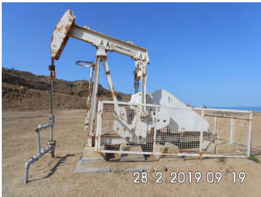
Fotografía 1. Pozo EA8297 (Coordenadas WGS84-zona 17S: 472300mE, 9525422mN), pozo productor tipo BM. Sin indicio de derrame de hidrocarburos ni alteración de suelo.
