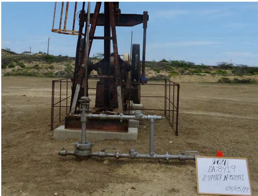
Fotografía 1. Pozo EA8419 (Coordenadas WGS84-zona 17S: 479167mE, 9528971mN), pozo productor tipo BM. Sin indicio de derrame de hidrocarburos ni alteración de suelo.
