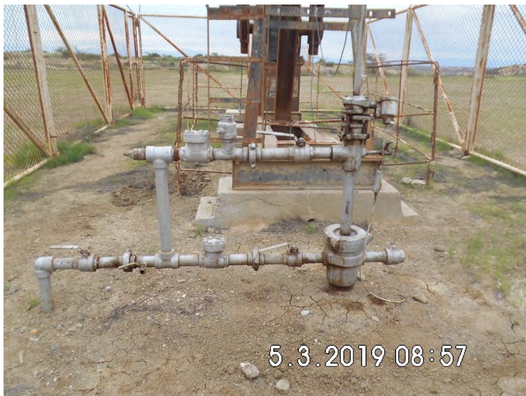
Fotografía 1. Pozo EA8461 (Coordenadas WGS84-zona 17S: 476022mE, 9529352mN), pozo productor tipo BM. Sin indicio de derrame de hidrocarburos ni alteración de suelo.
