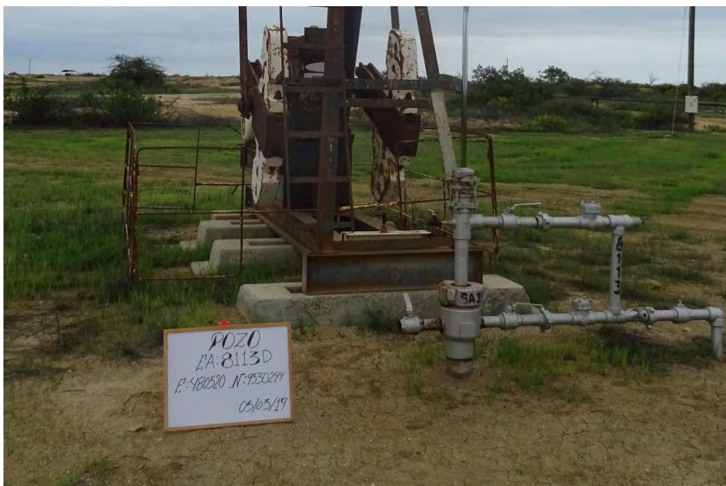
Fotografía 1. Pozo EA8113D (Coordenadas WGS84-zona 17S: 480520mE, 9530244mN), pozo productor tipo BM. Vista desde cerca del pozo. Sin indicio de derrame de hidrocarburos y alteración de suelo.
