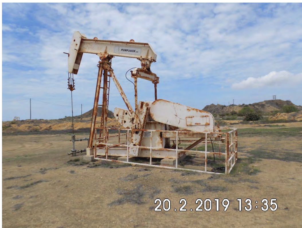
Fotografía 1. Pozo EA8269 (Coordenadas WGS84-zona 17S: 476702mE, 9525639mN), pozo productivo tipo BM. Vista desde cerca del pozo. Sin indicio de derrame de hidrocarburos ni alteración de suelo.
