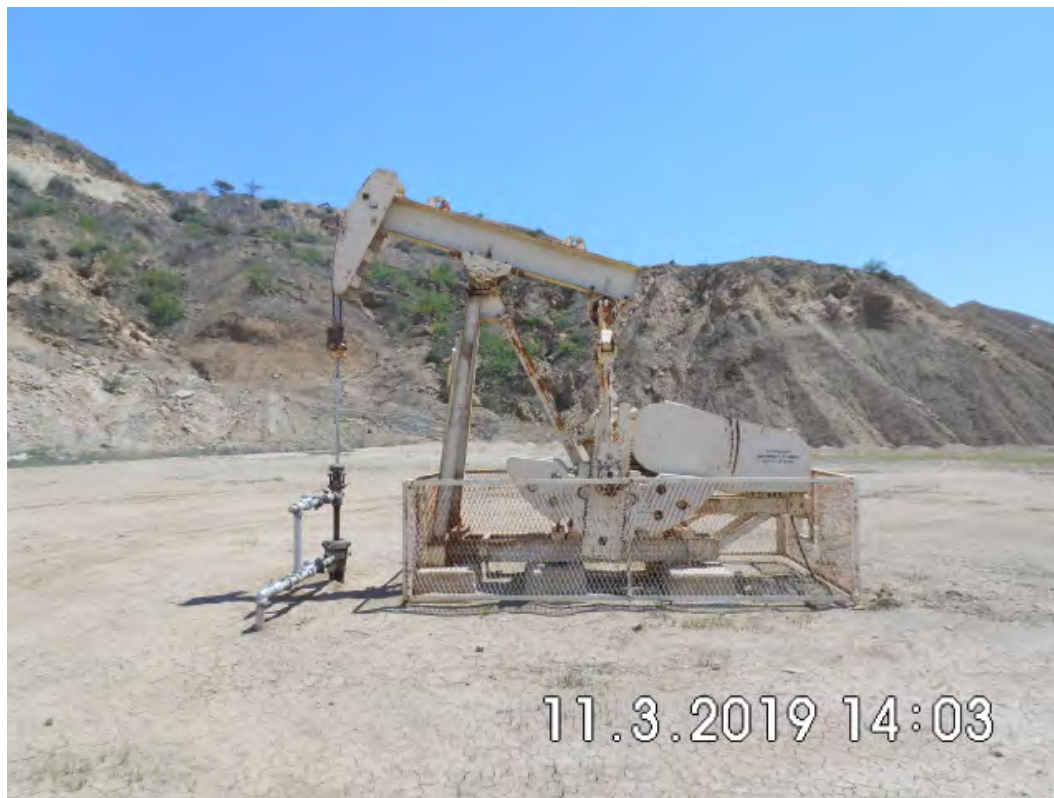
Fotografía 1. Pozo EA8249 (Coordenadas WGS84-zona 17S: 473805mE, 9527175mN), pozo productivo tipo BM. Vista desde cerca del pozo. Sin indicio de derrame de hidrocarburos ni alteración de suelo.
