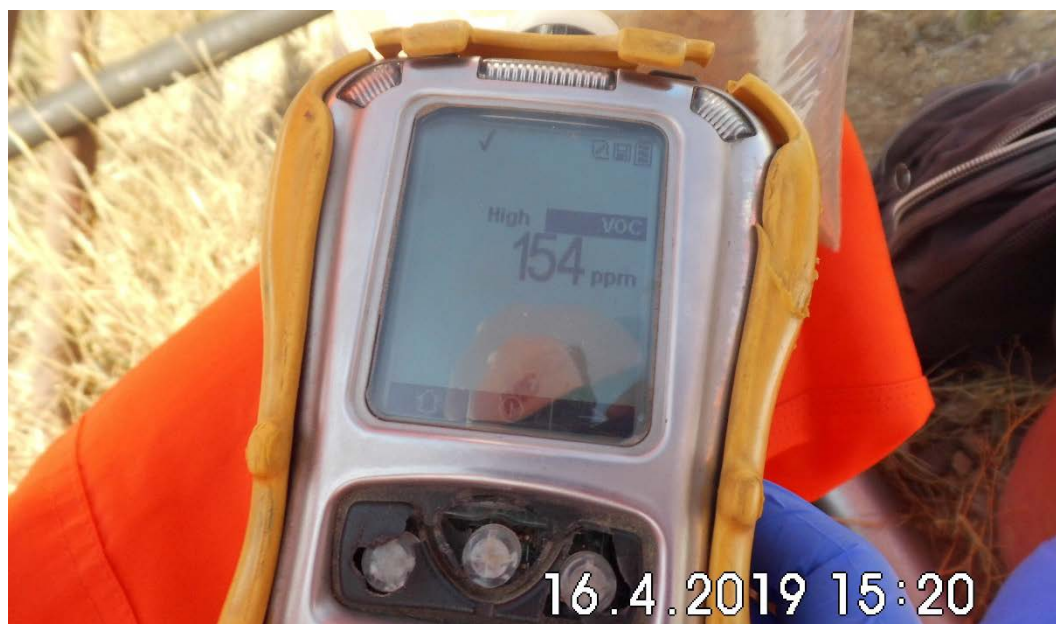
Fotografía 4: La selección de cada muestra de acuerdo a la lectura de VOC tomada en campo utilizando el PIT.
