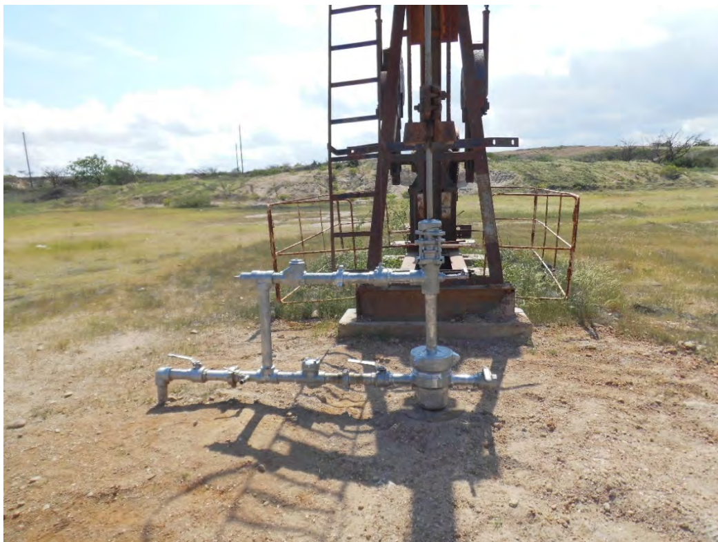
Fotografía 1. Pozo EA8587 (Coordenadas WGS84-zona 17S: 478857mE, 9529564mN), pozo productor tipo BM. Sin indicio de derrame de hidrocarburos ni alteración de suelo.
