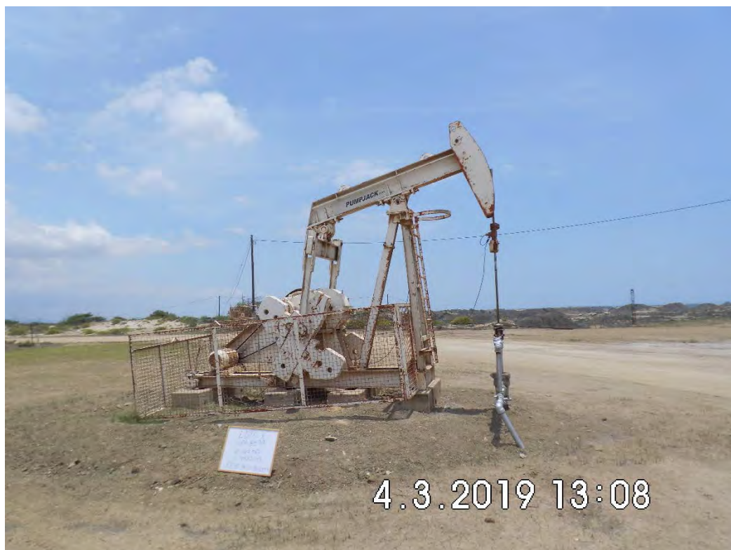
Fotografía 1. Pozo EA8599 (Coordenadas WGS84-zona 17S: 477967mE, 9527203mN), pozo productor tipo BM. Sin indicio de derrame de hidrocarburos ni alteración de suelo.
