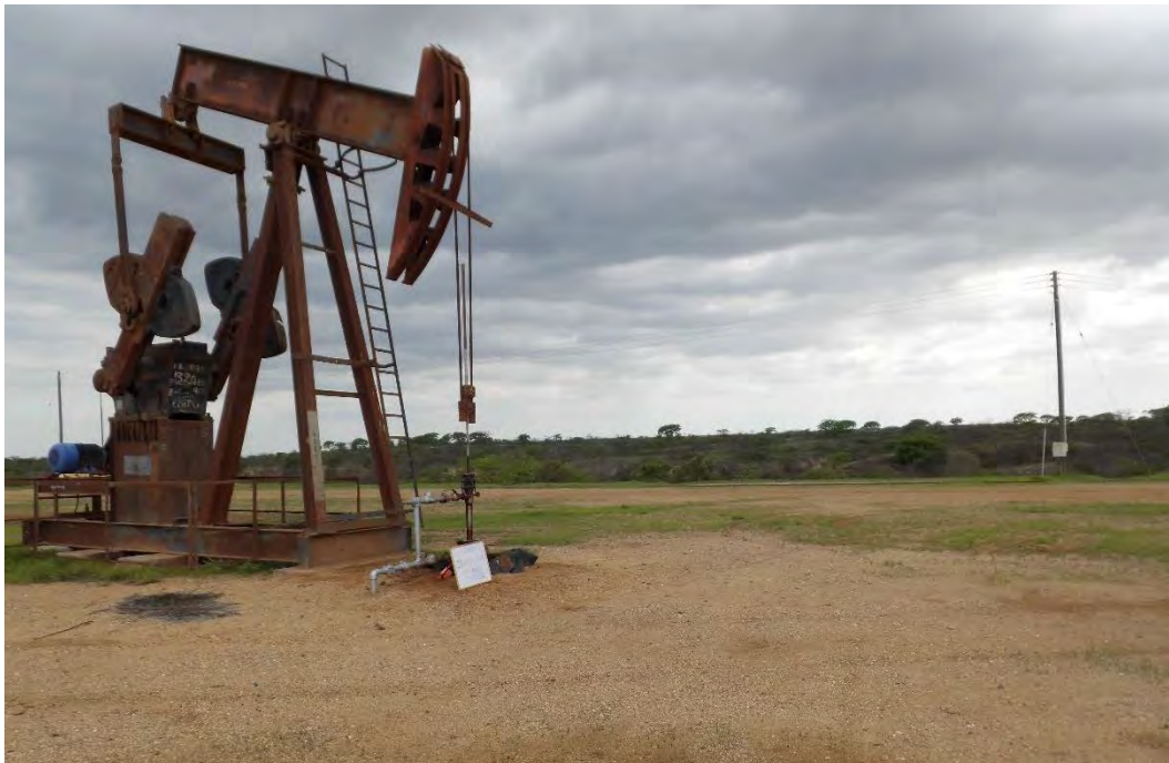
Fotografía 1. Pozo EA8061D (Coordenadas WGS84-zona 17S: 491926mE, 9532026mN), pozo productivo tipo BM. Vista desde cerca del pozo. Sin indicio de derrame de hidrocarburos ni alteración de suelo.
