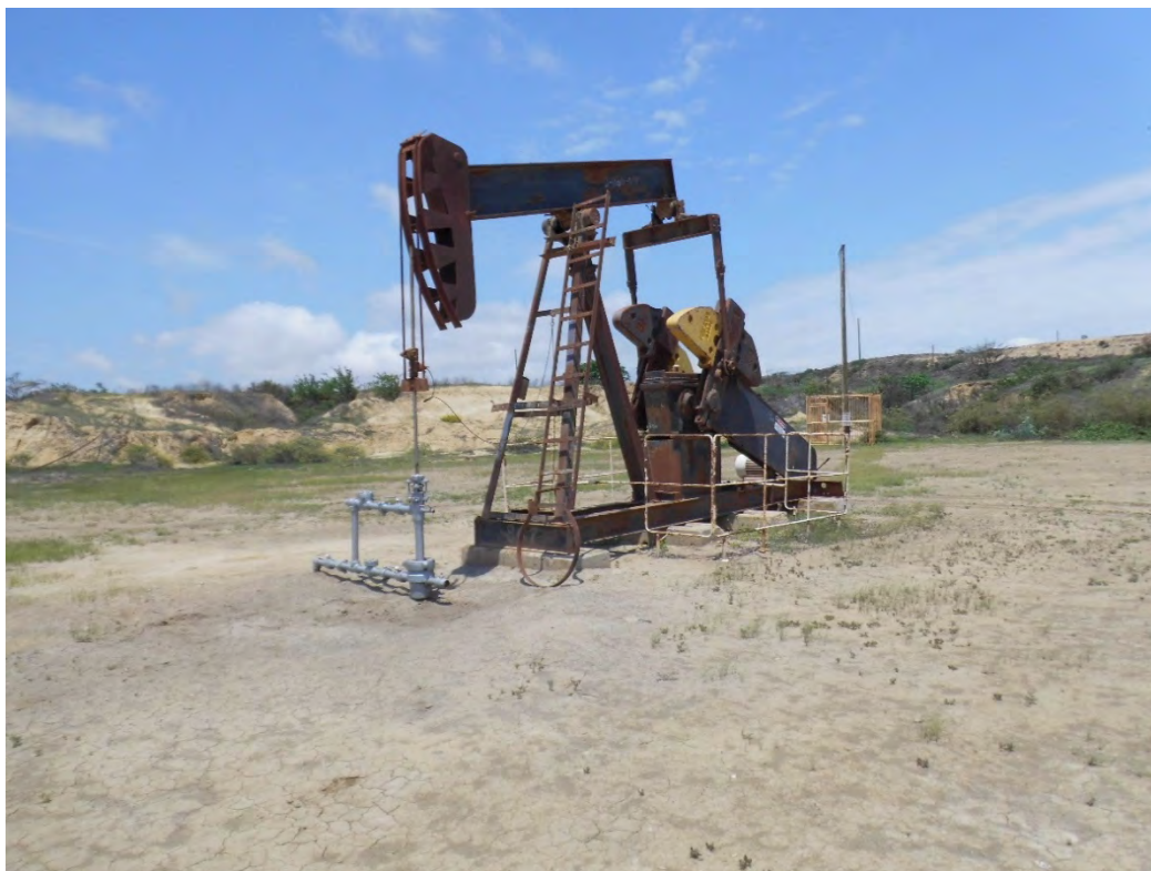
Fotografía 1. Pozo EA8493 (Coordenadas WGS84-zona 17S: 479069mE, 9530244mN), pozo productor tipo BM. Vista de cerca al pozo. Sin indicio de derrame de hidrocarburos ni alteración de suelo.
