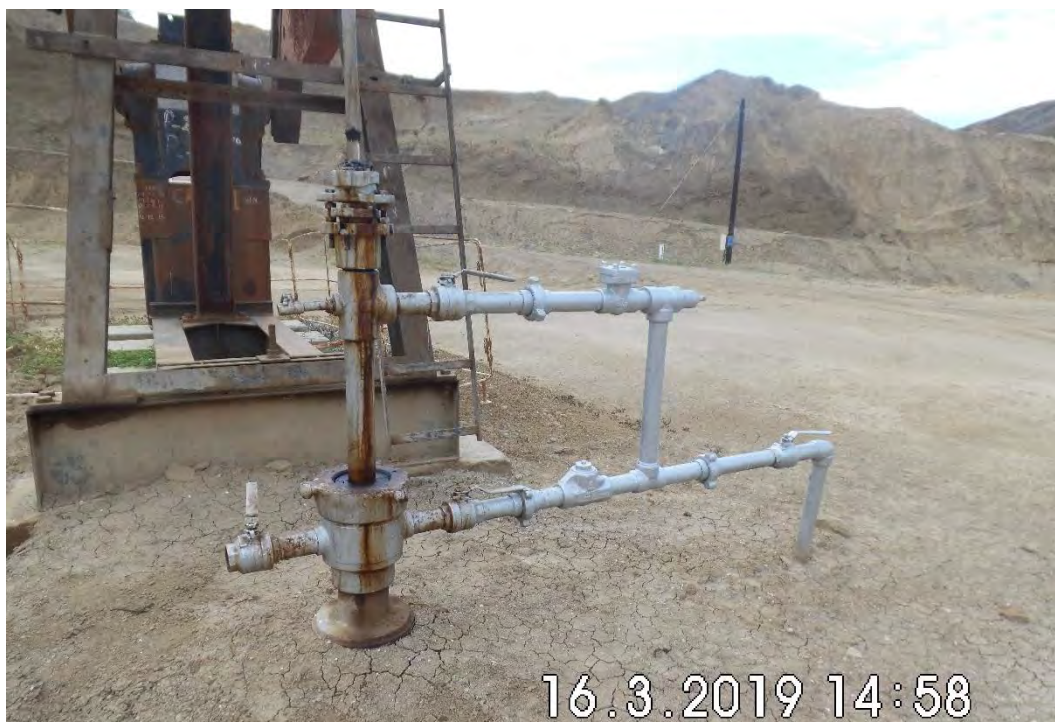
Fotografía 1. Pozo EA8001 (Coordenadas WGS84-zona 17S: 475723mE, 9524656mN), pozo productivo tipo BM. Vista desde cerca del pozo. Sin indicio de derrame de hidrocarburos ni alteración de suelo.
