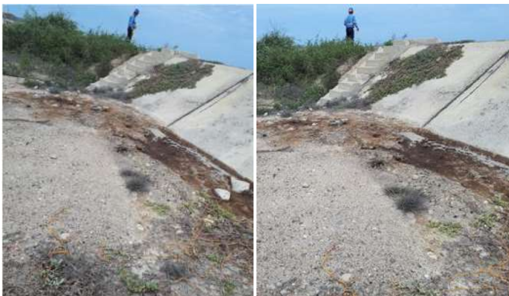
Fotografía 2. Indicio de afectación de hidrocarburos en el cuadrante norte del Patio de Tanque.
