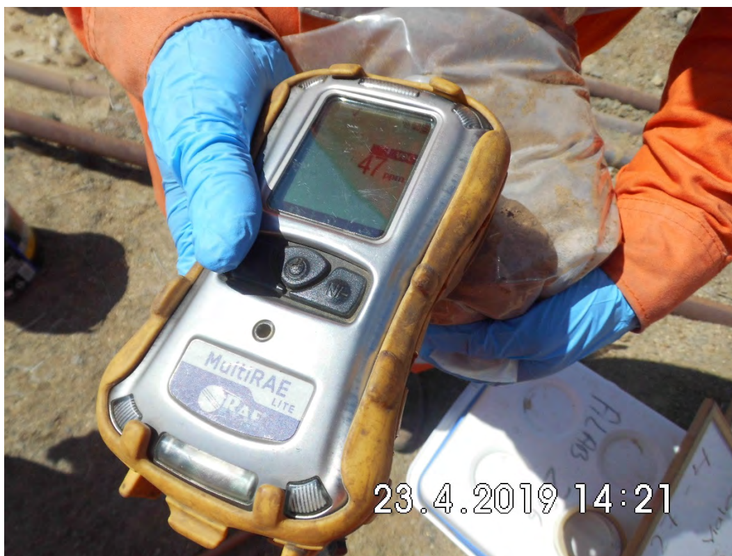
Fotografía 3. Selección de muestra de acuerdo a la lectura de VOC tomada en campo utilizando el PID.
