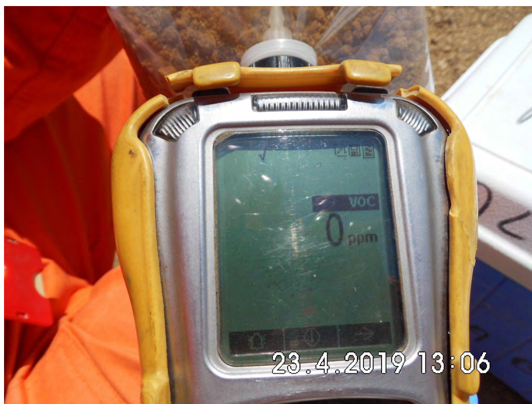
Fotografía 4: La selección de cada muestra de acuerdo a la lectura de VOC tomada en campo utilizando el PIT.
