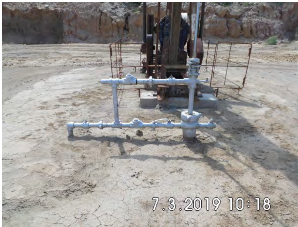
Fotografía 1. Pozo EA8131 (Coordenadas WGS84-zona 17S: 472759mE, 9527189mN), pozo productor tipo BM. Vista de cerca al pozo. Sin indicio de derrame de hidrocarburos ni alteración de suelo.
