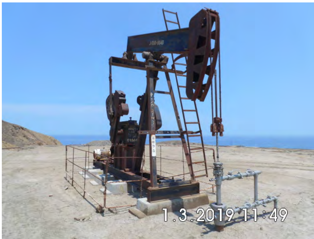
Fotografía 1. Pozo EA8098D (Coordenadas WGS84-zona 17S: 472501mE, 9527153mN), pozo productor tipo BM. Vista de cerca al pozo. Sin indicio de derrame de hidrocarburos ni alteración de suelo.
