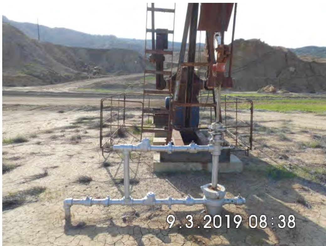
Fotografía 1. Pozo EA8282 (Coordenadas WGS84-zona 17S: 472562mE, 9525390mN), pozo productor tipo BM. Sin indicio de derrame de hidrocarburos ni alteración de suelo.
