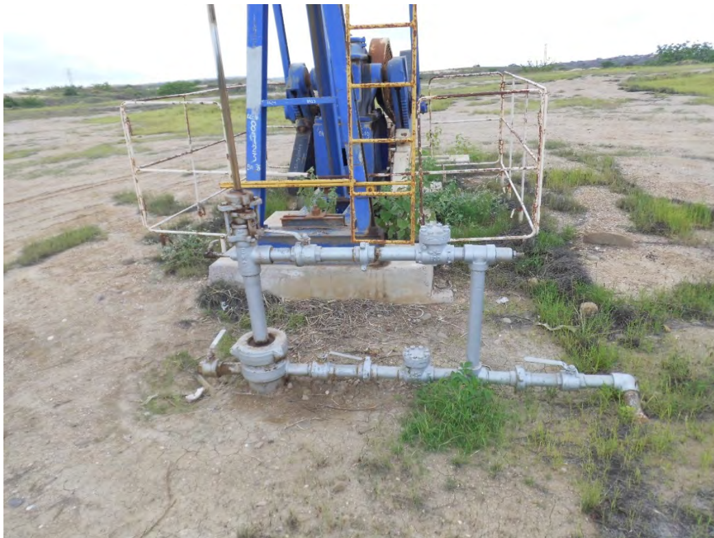
Fotografía 1. Pozo EA8723 (Coordenadas WGS84-zona 17S: 479911mE, 9530200mN), pozo productor tipo BM. Sin indicio de derrame de hidrocarburos ni alteración de suelo.
