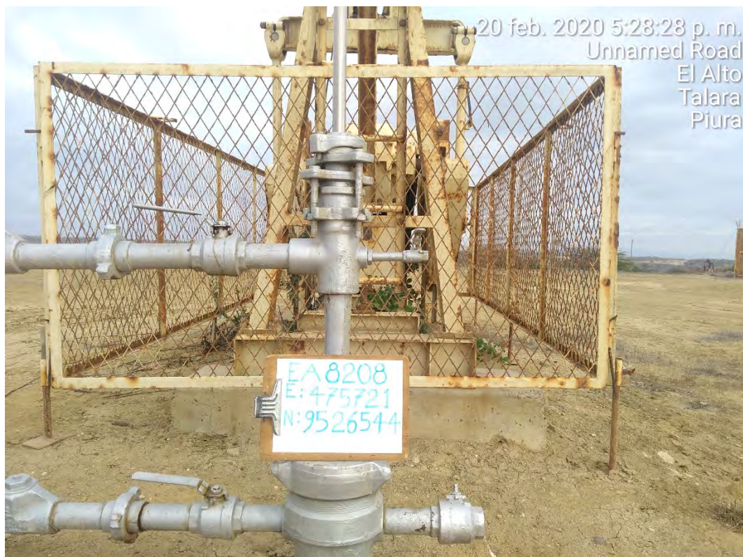
Fotografía 1. Pozo EA8208 (Coordenadas WGS84-zona 17S: 475721mE, 9526544mN), pozo productor tipo BM. Vista de cerca al pozo.
