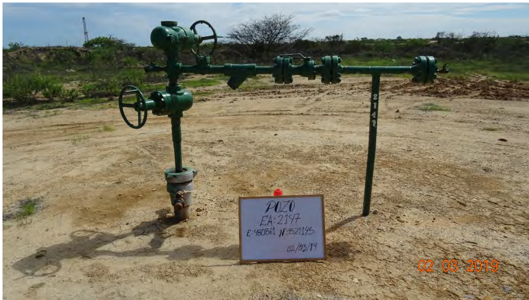
Fotografía 1. Pozo EA2147 (Coordenadas WGS84-zona 17S: 480861mE, 9529145mN), batería inyector tipo ACTINYA. Vista desde cerca del pozo. Sin indicio de derrame de hidrocarburos ni alteración de suelo.
