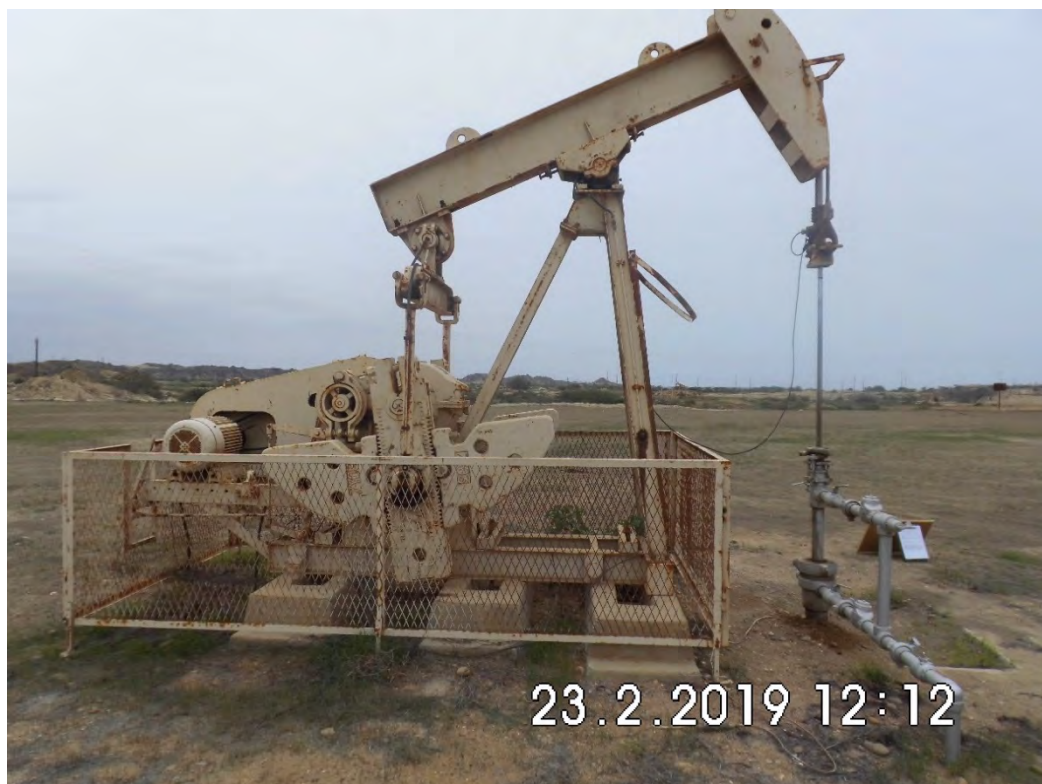
Fotografía 1. Pozo EA8496 (Coordenadas WGS84-zona 17S: 477472mE, 9527502mN), pozo productor tipo BM. Sin indicio de derrame de hidrocarburos ni alteración de suelo.
