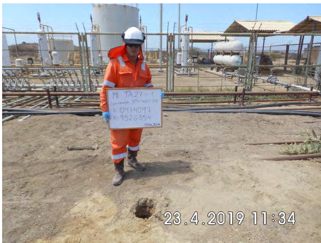
Fotografía 2. Batería TA-27. Muestreo de detalle (MI-TA27-1). Se evaluaron 6 puntos de muestreo de detalle. El intervalo de profundidad es de 0.25cm y la profundidad máxima es de 1 metro.
