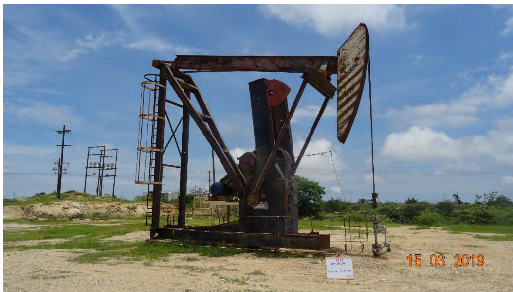
Fotografía 1. Pozo EA8114 (Coordenadas WGS84-zona 17S: 484886mE, 9530118mN), pozo productor tipo BM. Vista de cerca al pozo. Sin indicio de derrame de hidrocarburos ni alteración de suelo.
