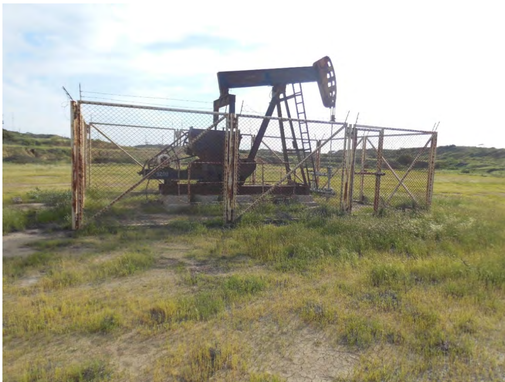
Fotografía 1. Pozo EA8672 (Coordenadas WGS84-zona 17S: 476533mE, 9529142mN), pozo productor tipo BM. Vista de cerca al pozo. Sin indicio de derrame de hidrocarburos ni alteración de suelo.
