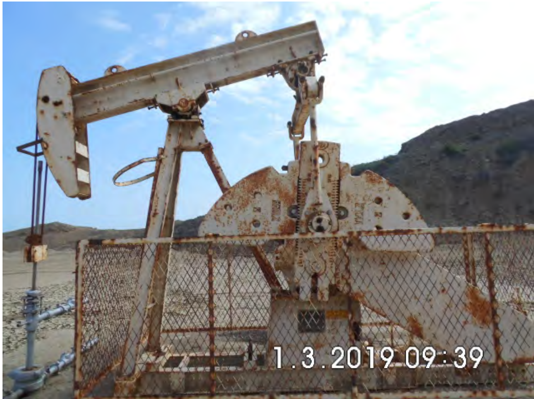
Fotografía 1. Pozo EA8180 (Coordenadas WGS84-zona 17S: 472313mE, 9526897mN), pozo productor tipo BM. Vista desde cerca del pozo. Suelo impregnado de hidrocarburo aproximadamente 4m 2 .
