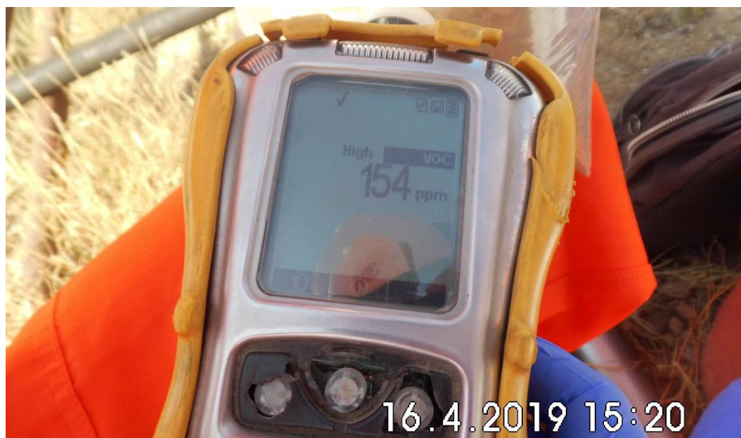
Fotografía 4: La selección de cada muestra de acuerdo a la lectura de VOC tomada en campo utilizando el PIT.
