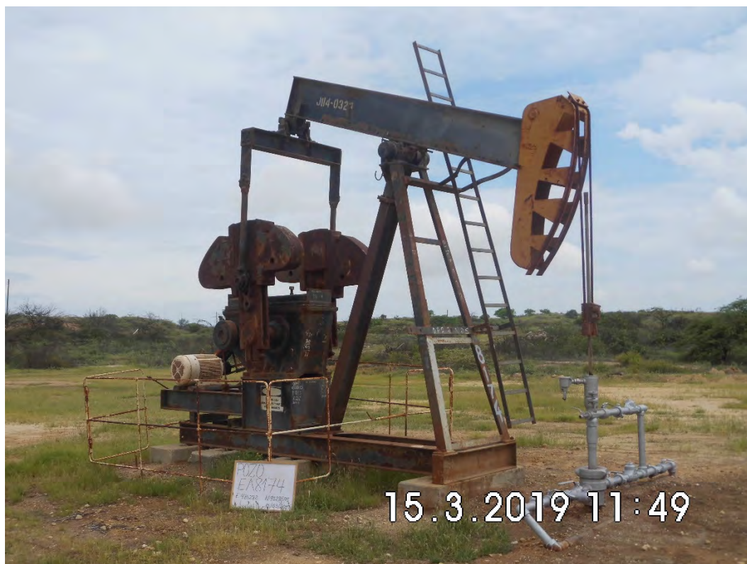
Fotografía 1. Pozo EA8174 (Coordenadas WGS84-zona 17S: 485282mE, 9528595mN), pozo productivo tipo BM. Vista desde cerca del pozo. Sin indicio de derrame de hidrocarburos ni alteración de suelo.
