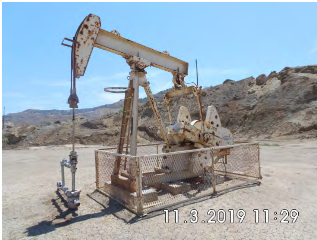
Fotografía 1. Pozo EA8258 (Coordenadas WGS84-zona 17S: 473538mE, 9527448mN), pozo productivo tipo BM. Vista desde cerca del pozo. Sin indicio de derrame de hidrocarburos ni alteración de suelo.
