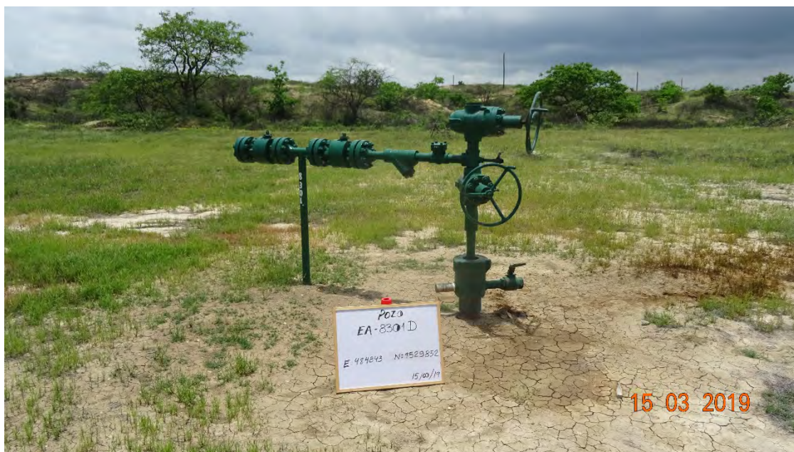
Fotografía 1. Pozo EA8301D (Coordenadas WGS84-zona 17S: 484843mE, 9529852mN), pozo inyector tipo ACTINYA. Vista desde cerca del pozo. Sin indicio de derrame de hidrocarburos y alteración de suelo.
