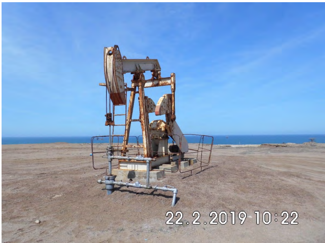
Fotografía 1. Pozo EA8164 (Coordenadas WGS84-zona 17S: 471648mE, 9523591mN), pozo productor tipo BM. Vista de cerca al pozo. Sin indicio de derrame de hidrocarburos ni alteración de suelo.
