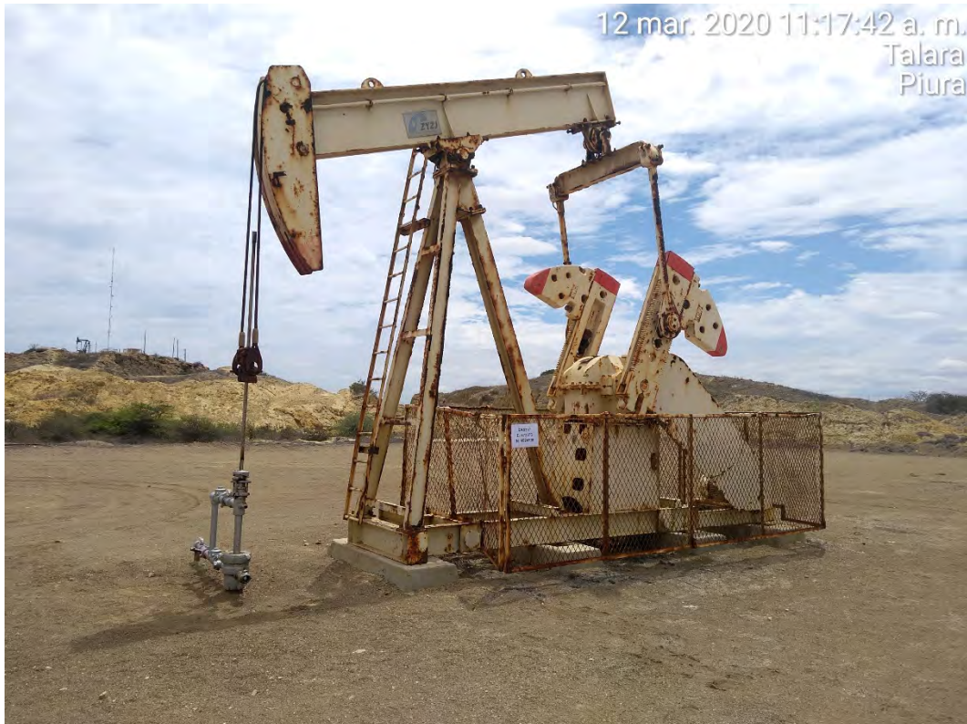
Fotografía 1. Pozo EA8357 (Coordenadas WGS84-zona 17S: 473073mE, 9524138mN), pozo productor tipo BM. Vista desde cerca del pozo.
