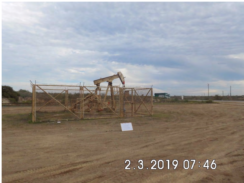
Fotografía 1. Pozo EA8178 (Coordenadas WGS84-zona 17S: 478175mE, 9527868mN), pozo productor tipo BM. Sin indicio de derrame de hidrocarburos ni alteración de suelo.
