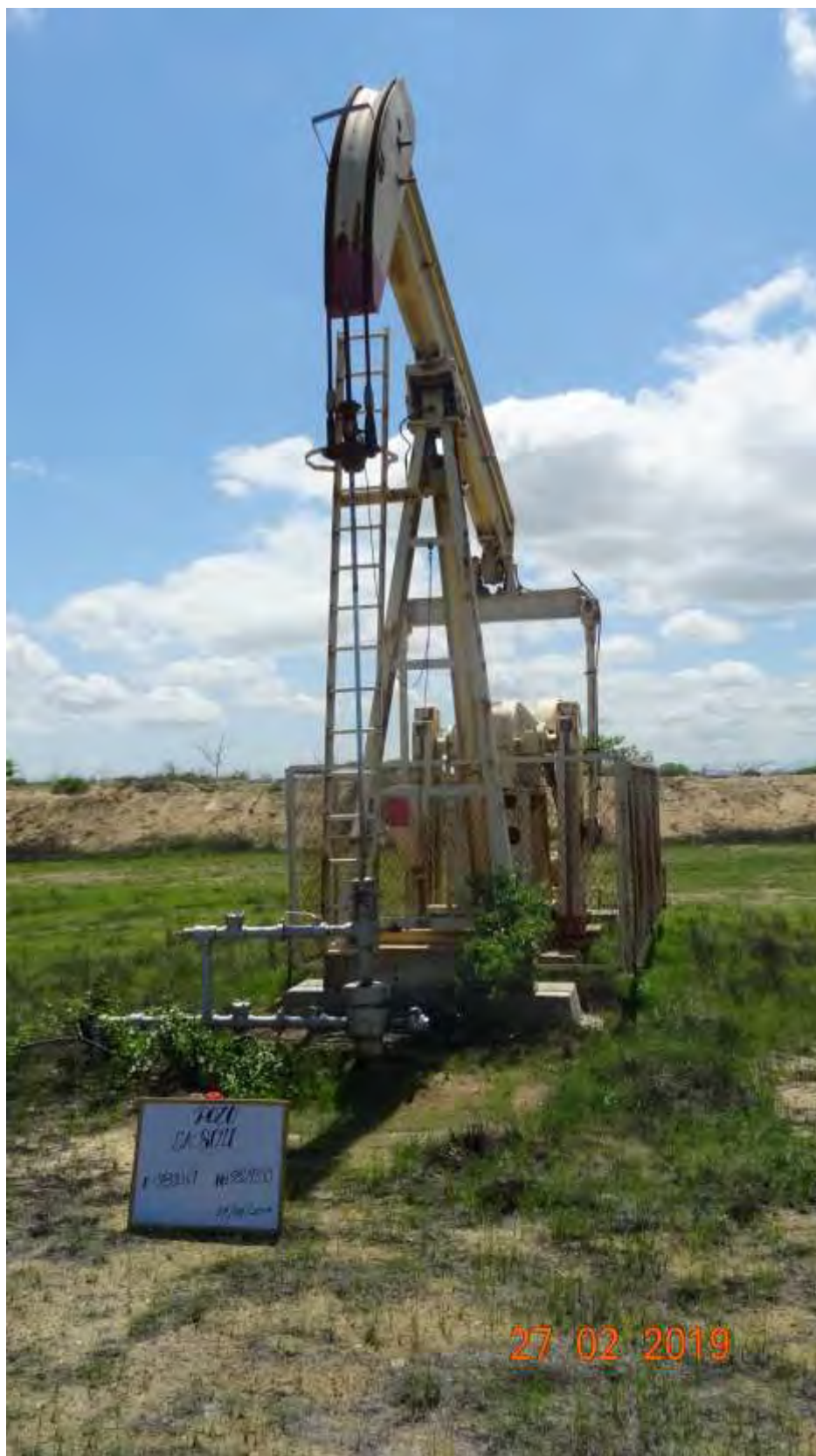
Fotografía 1. Pozo EA8091 (Coordenadas WGS84-zona 17S: 483369mE, 9529350mN), pozo productivo tipo BM. Vista desde cerca del pozo. Sin indicio de derrame de hidrocarburos ni alteración de suelo.
