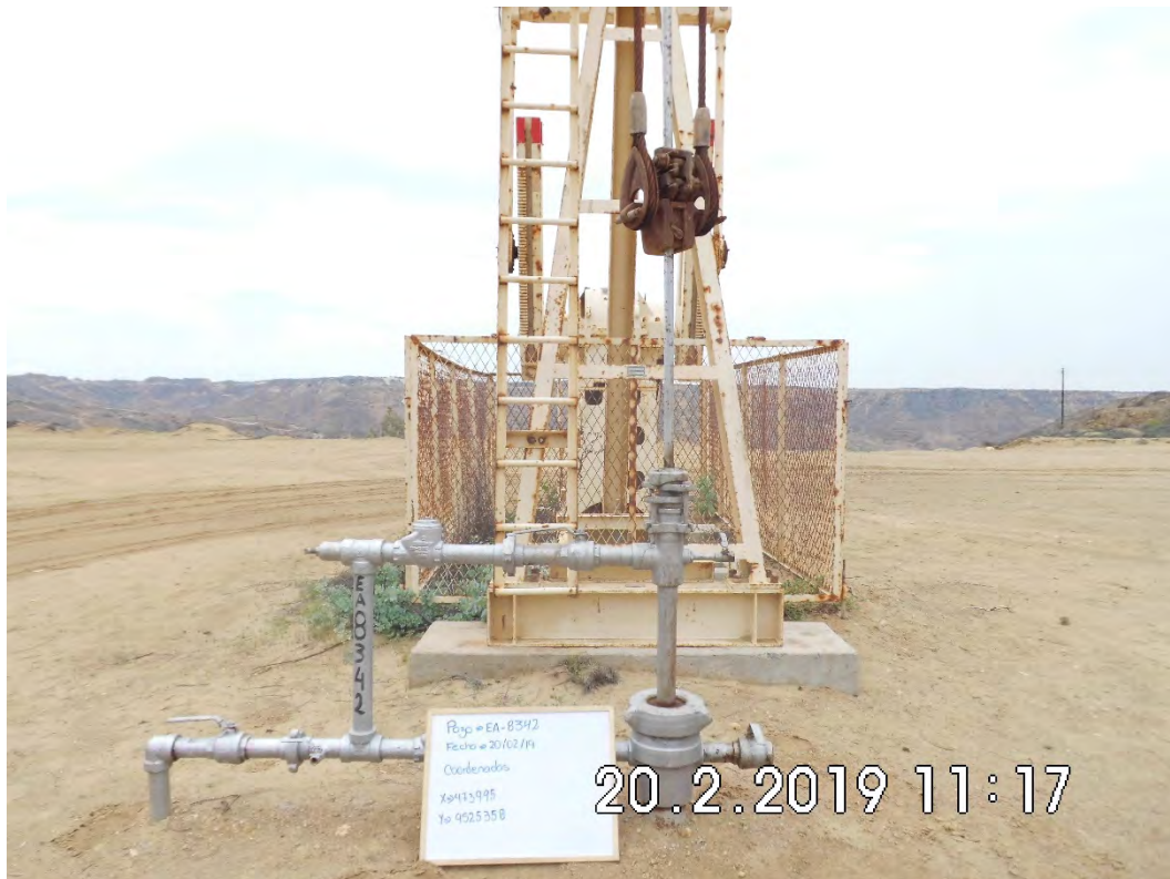
Fotografía 1. Pozo EA8342 (Coordenadas WGS84-zona 17S: 473995mE, 9525358mN), pozo productor tipo BM.
