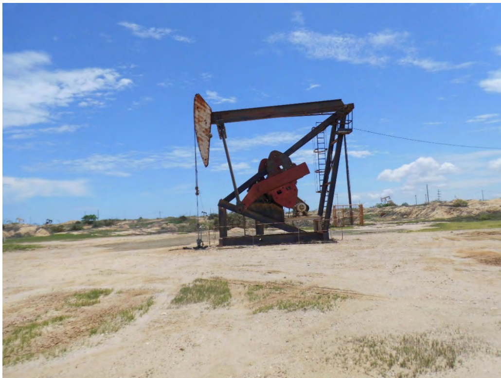
Fotografía 1. Pozo EA8109 (Coordenadas WGS84-zona 17S: 482815mE, 9530929mN), pozo productor tipo BM. Vista desde cerca del pozo. Sin indicio de derrame de hidrocarburos ni alteración de suelo.
