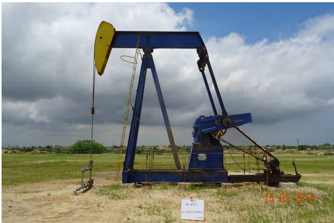
Fotografía 1. Pozo EA8321 (Coordenadas WGS84-zona 17S: 484722mE, 9529906mN), pozo productor tipo BM. Vista de cerca al pozo. Sin indicio de derrame de hidrocarburos ni alteración de suelo.
