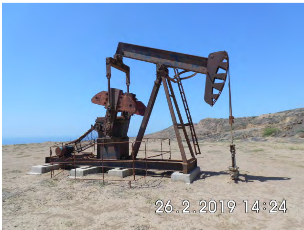
Fotografía 1. Pozo EA8743 (Coordenadas WGS84-zona 17S: 472866mE, 9524774mN), pozo productor tipo BM. Vista de cerca al pozo. Sin indicio de derrame de hidrocarburos ni alteración de suelo.
